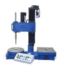
Вертикально работающий шлифовальный и притирочный станок предназначен для обработки уплотнительных поверхностей арматуры, например, в вентилях, клапанах, предохранительных клапанах, фланцах, задвижках, шиберах, обратных клапанах, клиньев задвижек и пластин шиберов. Благодаря компактной конструкции этот станок можно использоваться как стационарно в мастерских, так и непосредственно на месте установки арматуры.
