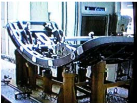
Дверь «FALCON» Dassault на CRENEAU UGV 5 axes
