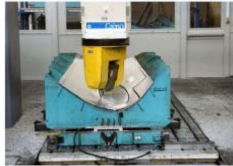
Механическая обработка оболочки фюзеляжа «FALCON» Dassault
