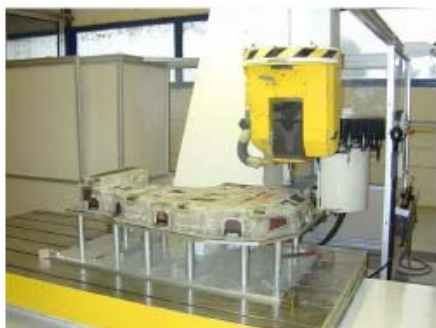
Приспособление для обработки приборного щитка вертолётa NH90 DAHER LHOTELLIER
