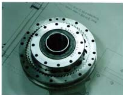
Эпициклоидный редуктор с зацеплением большого количества зубьев
