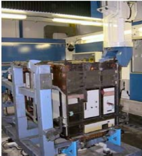
Механическая обработка центральной части Евровертолёта ТИГР
