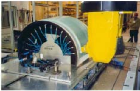
Алюминиевая крышка двигателя, обрабатываемая CRENEAU UGV 5 axes с удалением стружки и вакуумным приспособлением.
